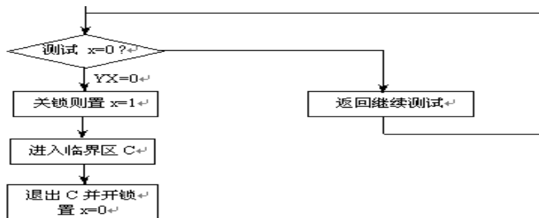
图 2-6 lock 和 unlock 流程图
